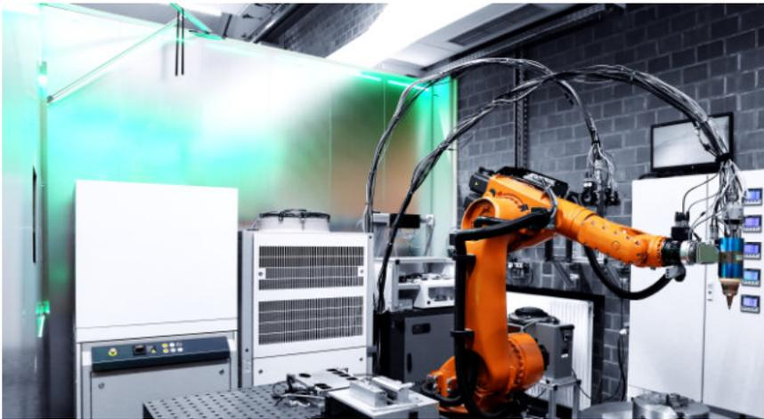
Smart Shield ist ein nachrüstbares und vollautomatisierbares Laserschutz-System auf der Laser zugewandten Seite, welches die bestehende Schutzwand als passiven Schutz für die Dauer des Abschaltvorgangs mit nutzt.
